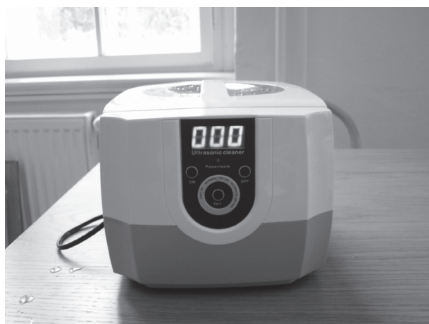
Obr. 4 Ultrasonická čistička CD-4800 využívaná v traseologické laboratoři HMČ UK při FHS UK – Fig. 4 Ultrasonic cleaning tank CD-4800 used in traseological laboratory HMČ UK at FHS UK
