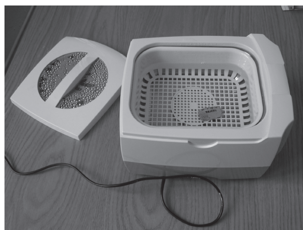
Obr. 4 Ultrasonická čistička CD-4800 využívaná v traseologické laboratoři HMČ UK při FHS UK – Fig. 4 Ultrasonic cleaning tank CD-4800 used in traseological laboratory HMČ UK at FHS UK
